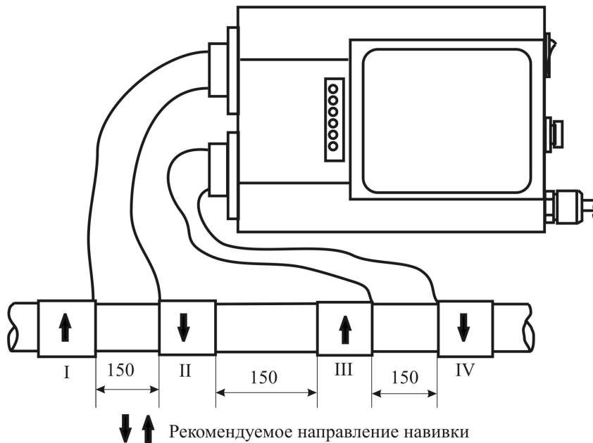
Рисунок 1 Условная схема монтажа прибора и проводов излучателей.
